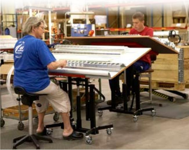
Praktische Tische, die u.a. für Einpack-, Sortierungs- oder Montagearbeiten sehr gut geeignet sind. Die Tische sind sehr flexibel in der Anwendung, lassen sich schnell verschieben und sind einfach in sowohl Tischplattenhöhe als auch -winkel verstellbar.
