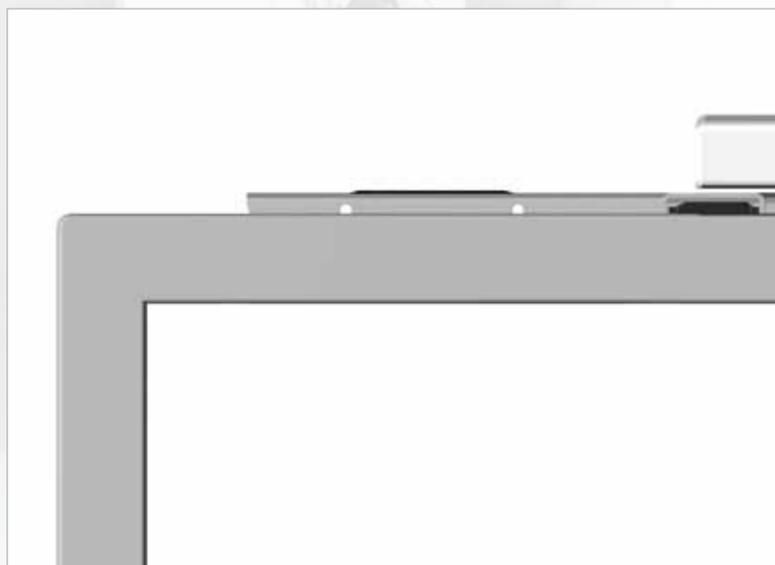
Die Stabilität und Maßgenauigkeit der ALEO Seitenteile beruht auf dem „Knickholmprinzip“. Jedes Seitenteil besteht aus einem durchgängigen Stahlrohr, das maßgenau ausgeklinkt und verschweißt wird.
