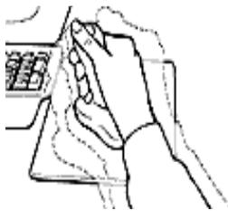
Die Hand umfasst den Griff und die Handkante liegt auf dem tellerförmigen Standfuß auf. Im Gegensatz zur konventionellen Maus, liegt die Hand nicht flach parallel zum Tisch, sondern sie steht senkrecht zur Tischfläche. Die Maus wird, wie eine Standardmaus, über die Tischfläche bewegt. Zum Klicken der Maustasten steht ein Wippschalter zur Verfügung, der mit dem Daumen bedient wird. Die Roll-Wipptaste (scrolling) wird mit dem Mittel- und Ringfinger gedrückt.
